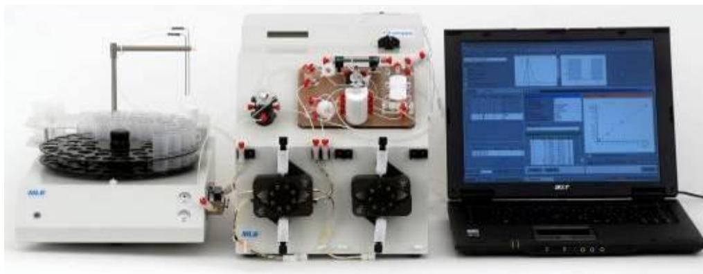
1. ábra: FIA-rendszer Univerzális Metód Módszerrel
